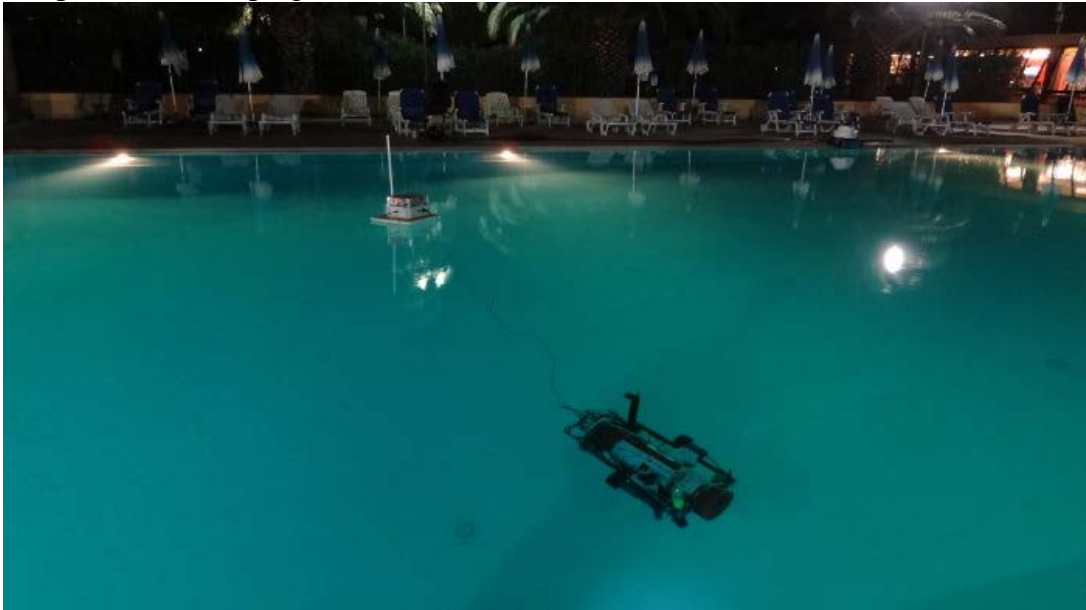
Photo 3 : Tests de régulation pour Saucisse (Autonomous Underwater Vehicle) dans une piscine du camping
